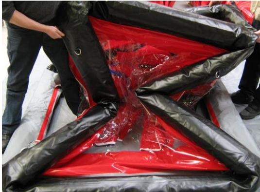
**1.** Während des Ablassens der Luft dafür sorgen, dass die vier Säulen in der Mitte eingeschlagen und auf dem Duschkörper in Sternform zusammengelegt werden.
